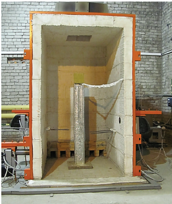
Универсальная печь для огневых испытаний строительных конструкций
