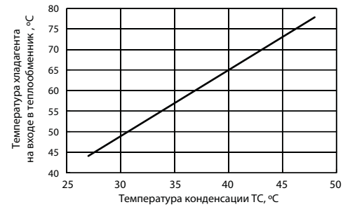
Рис. 2. Температура хладагента на входе в теплообменник
