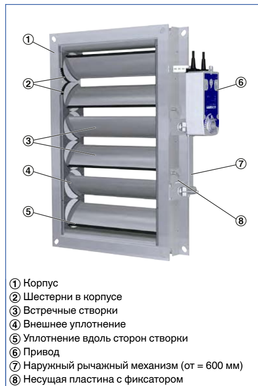
Схематическое изображение JZ-LL-AL
