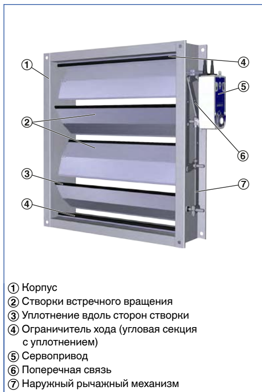
Схематическое изображение JZ-HL
