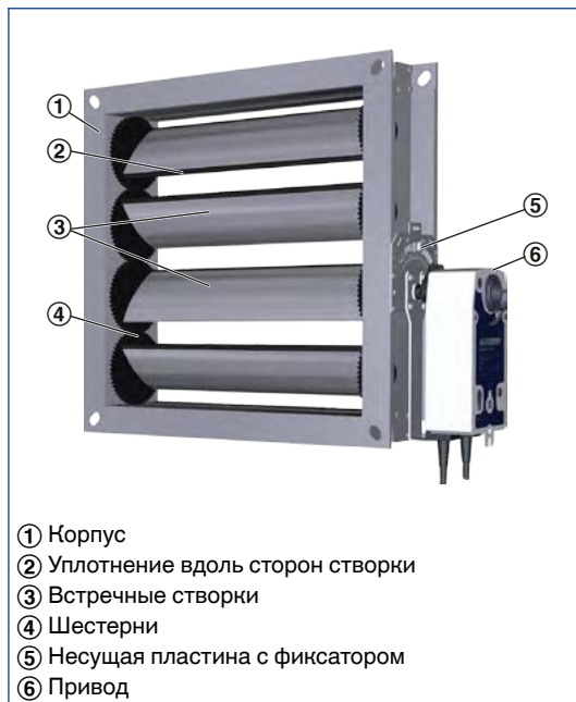
Схематическое изображение JZ-HL-AL
