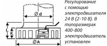
Регулирование с помощью электродвигателя 24 В (2-10 В). В типоразмерах 400-800 электродвигатель установлен внутри, а в типоразмере 300 - снаружи
