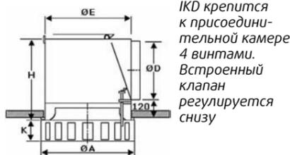
IKD крепится к присоединительной камере 4 винтами. Встроенный клапан регулируется снизу
