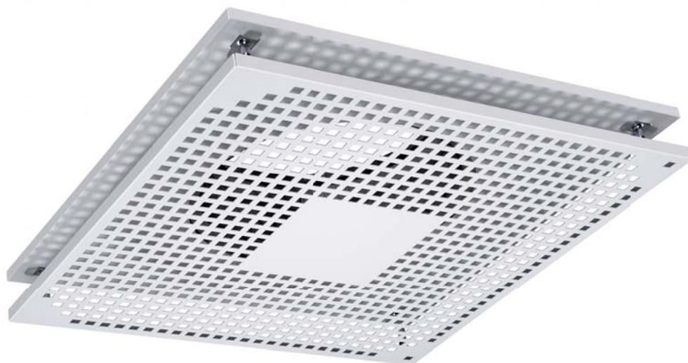
Воздух подается в помещение через боковые щели в горизонтальном направлении и через переднюю перфорированную панель воздухораспределителя в вертикальном направлении, при этом обеспечивается высокая интенсивность перемешивания приточного воздуха с воздухом в помещении.
