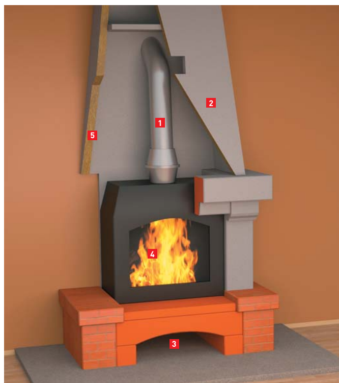
Рисунок 11. Принципиальная схема фальшкамина:
